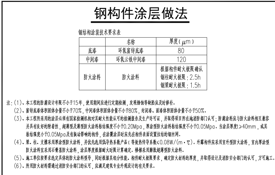
图5 钢结构涂层做法
